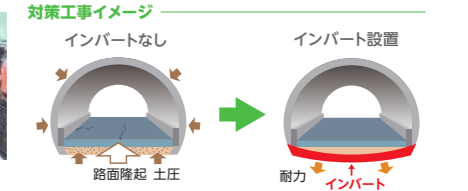
トンネルインバート打設工事(例)
