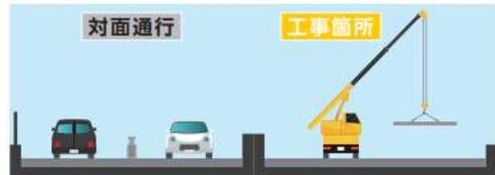
通行止めをおこなわず両方向の通行を確保する対面通行規制など、可能な限り交通への影響を抑えられる工事方法を実施していきます。
