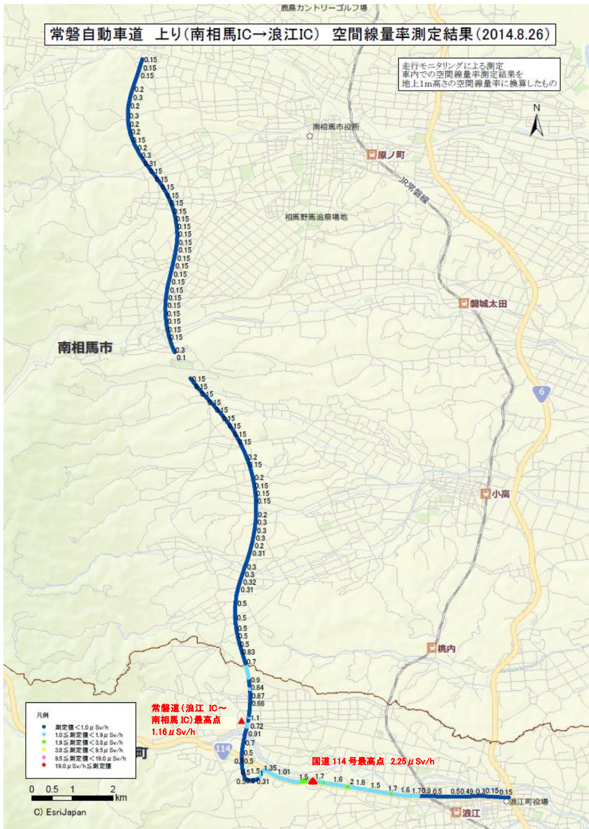
図3 モニタリングカーによる測定結果から算出した道路上の車外の空間線量率(上り)
