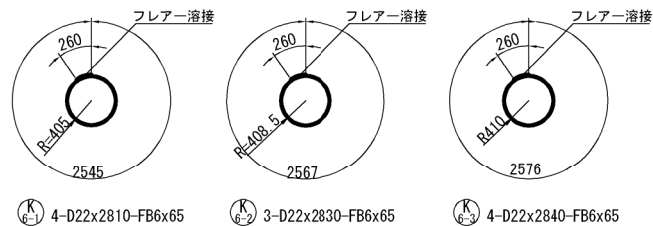
フレア溶接詳細図 S=1:25
