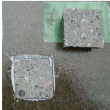
破断面にレイタンスなし
