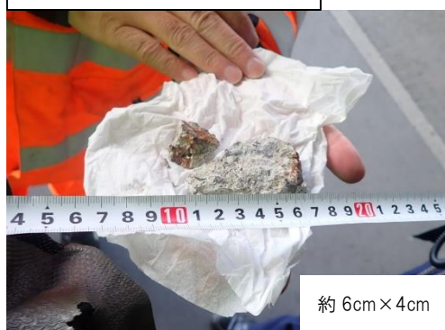
落下し飛散したコンクリート片
