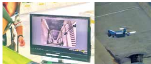
ドローンによる橋りょう点検イメージ
