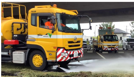
【散水ノズルの改良】
