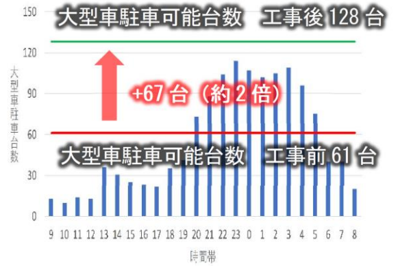
図-4 E4 東北道 那須高原 SA(下り)平日の大型車時間帯別駐車台数と駐車可能台数 ※大型駐車台数は工事前の2019年9月時点
